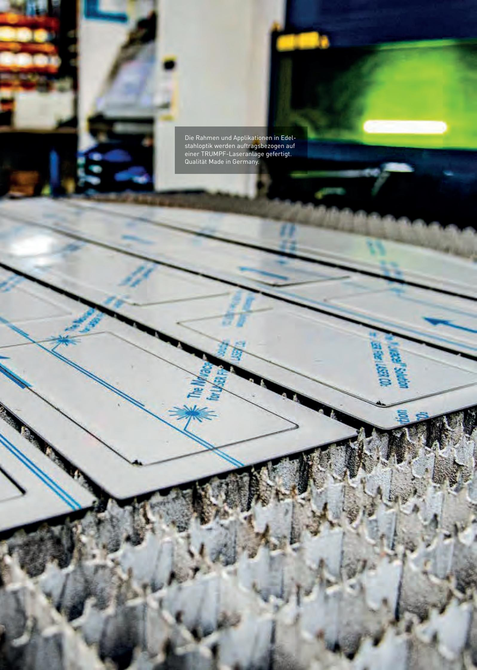
Die Rahmen und Applikationen in Edeltstahl-optik werden auftragsbezogen auf einer TRUMPF-Laseranlage gefertigt. Qualität Made in Germany.
