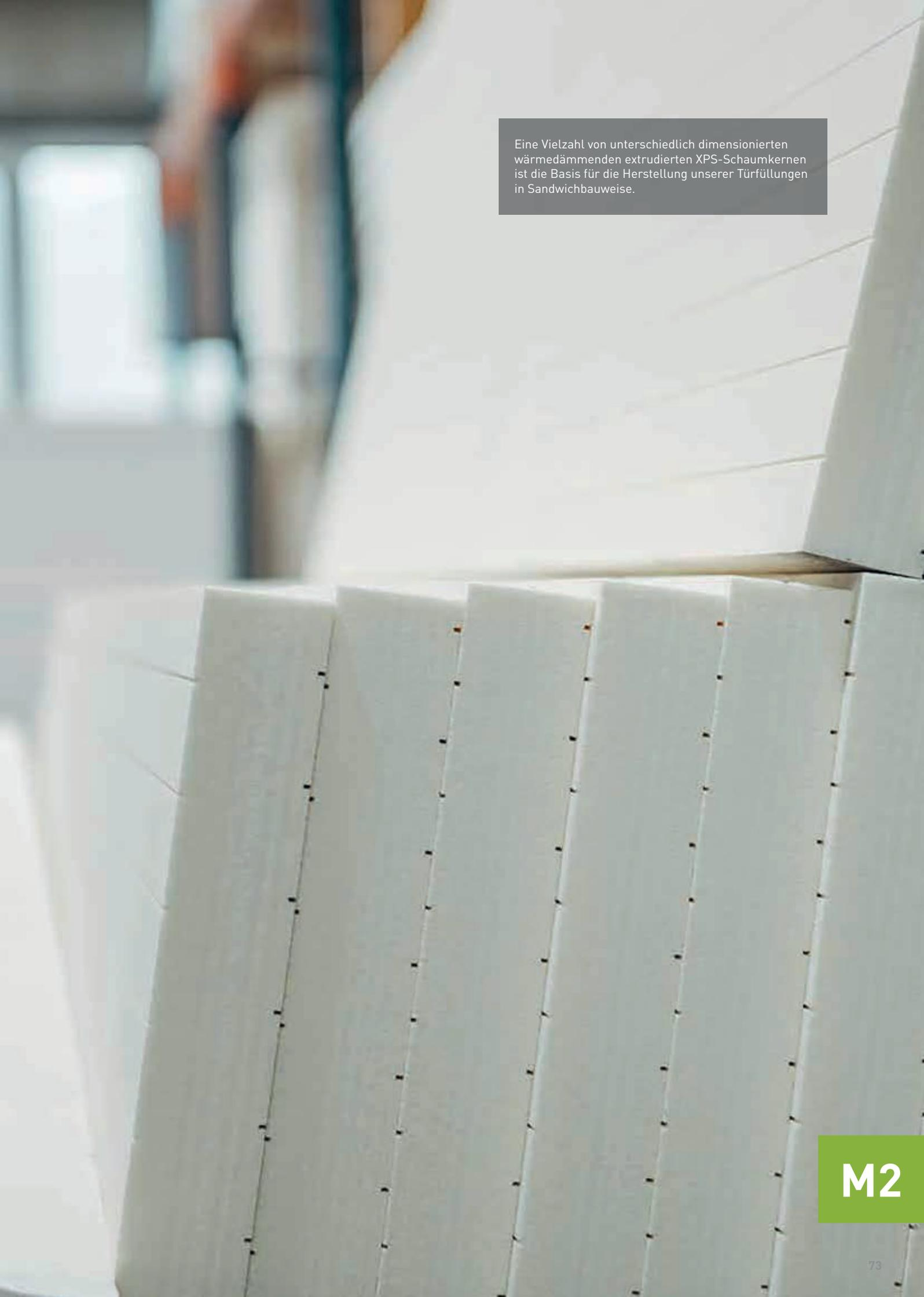
Eine Vielzahl von unterschiedlich dimensionierten wärmedämmenden extrudierten XPS-Schaumkernen ist die Basis für die Herstellung unserer Türfüllungen in Sandwichbauweise.
