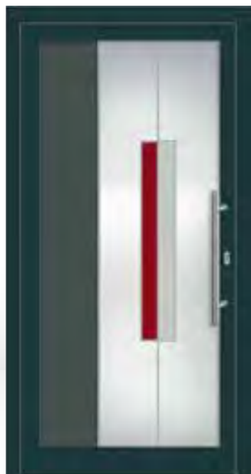
V-012 Ansicht A / DIN rechts mit Farbfeldern Ganzglasfüllung [2-fach Glas Ug 1,1] außen ESG, helle Flächen mattiert, dunkle Streifen Klarglas Dekorfeld 1: opak dunkelgrau Dekorfeld 2: opak rot Dekorfeld 3: opak hellgrau ■ Griff ZAE 6s, 600 mm | PG 6
