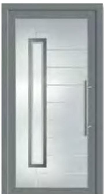
V-457 Ansicht A / DIN rechts Ganzglasfüllung 3-fach Glas Ug 1,7 bei 28 mm und Ug 1,1 bei 36 mm helle Flächen mattiert, dunkle Streifen Klarglas, rechteckige Rahmenapplikation in Edelstahloptik ■ Griff ZAE 6s, 600 mm | PG 60
