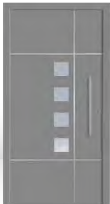
M-549 Ansicht A / DIN rechts J ■ Aufsatzfüllung ■ Farbe Graualuminium ähnl. RAL 9007 Feinstruktur ■ Isolierglas Satinato weiß | GG 2 ■ flächenbündige Streifenapplikationen in Edelstahloptik außen ■ Griff ZAE 6, 600 mm | PG 8
