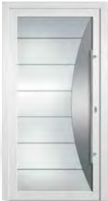
V-492 Ansicht A / DIN rechts Ganzglasfüllung 3-fach Glas Ug 1,7 bei 28 mm und Ug 1,1 bei 36 mm dunkle Streifen Klarglas, helle Flächen mattiert, bogenförmige Applikation in Edelstahloptik ■ Griff ZAE 6s, 1200 mm | PG 7
