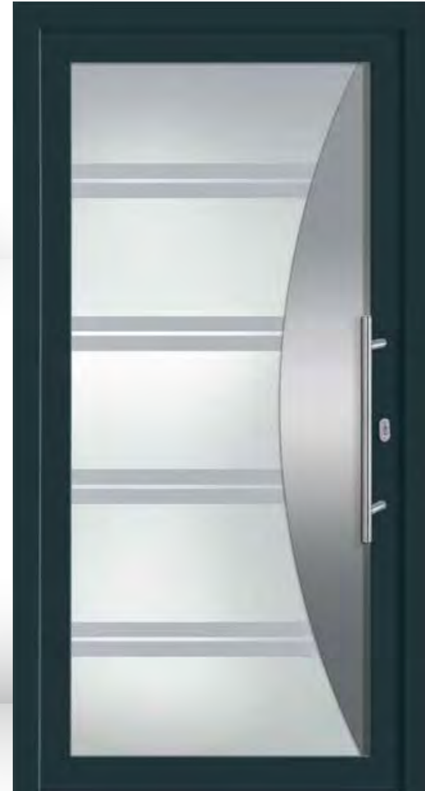
V-473 Ansicht A / DIN rechts Ganzglasfüllung 3-fach Glas, Ug 1,7 bei 28 mm und Ug 1,1 bei 36 mm bogenförmige Applikation in Edelstahloptik, helle Flächen mattiert, dunkle Streifen Klarglas ■ Griff ZAE 6s, 600 mm | PG 6
