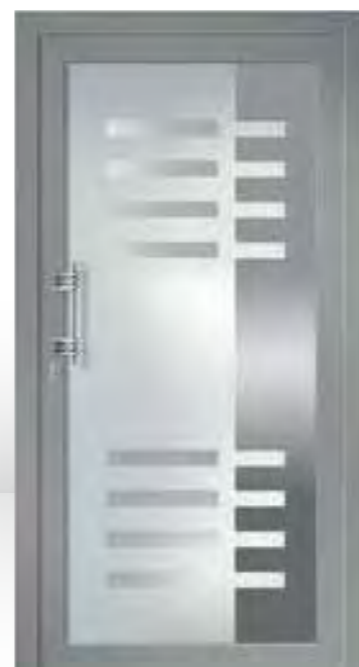
V-472 Ansicht A / DIN links Ganzglasfüllung 3-fach Glas Ug 1,7 bei 28 mm und Ug 1,1 bei 36 mm helle Flächen mattiert, dunkle Streifen Klarglas, kammartige Applikation in Edelstahloptik ■ Griff ZAE 134, 320 mm | PG 11
