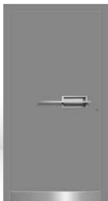
M-400 A ■ Aufsatzfüllung ■ Farbe Graualuminium ähnl. RAL 9007 Feinstruktur ■ Griff ZAE 167 | PG 14 (Mindestfüllungsstärke 40 mm) ■ Trittschutz TS 2
