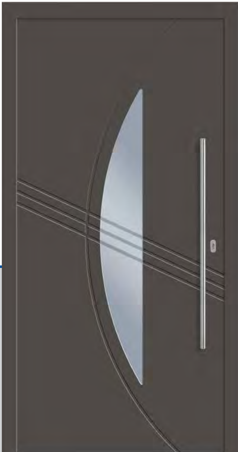
ALUSTAR 5219 Ansicht A / DIN rechts Flachnuten außen Farbe Eisenglimmer (DB 703) Motivglas K 474 Griff ZAE 6, 1000 mm
